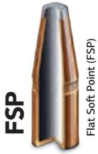
Bala con chaqueta metálica parcial y punta plana de plomo. Adecuada para rifles con cargadores tubulares, ya que reduce el riesgo de ignición accidental del fulminante debido al retroceso. Buena penetración y poder de expansión.
