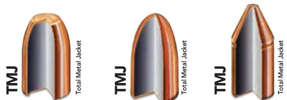
Bala con chaqueta metálica integral que no deja plomo al descubierto. A diferencia de la bala FMJ, la base también está cubierta por la chaqueta. Esto evita la vaporización del plomo al disparar. Perfecta para disparo en interior.
