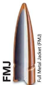
Bala con chaqueta metálica completa, solamente abierta en la base. Bala no expandible con un alto poder de penetración debido a su forma puntiaguda. Recomendada para tiro al blanco y caza menor, ya que provocan en la presa un mínimo daño en el tejido y un pequeño orificio de salida.
