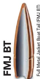
Bala con chaqueta metálica completa, solamente abierta en la base. Bala no expandible con un alto poder de penetración debido a su forma puntiaguda. Diseño aerodinámico que reduce la resistencia del aire. Desarrolla mayor coeficiente balístico que la FMJ.
